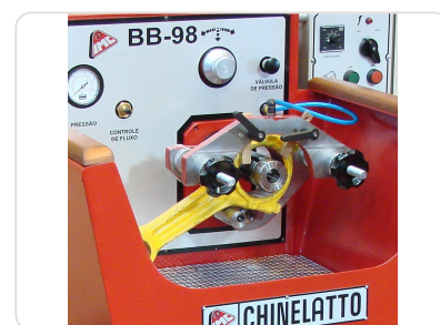
Sistema de fijación con dispositivo amarillo para bielas en bruñidora diamantada BB-98 Chinelatto
