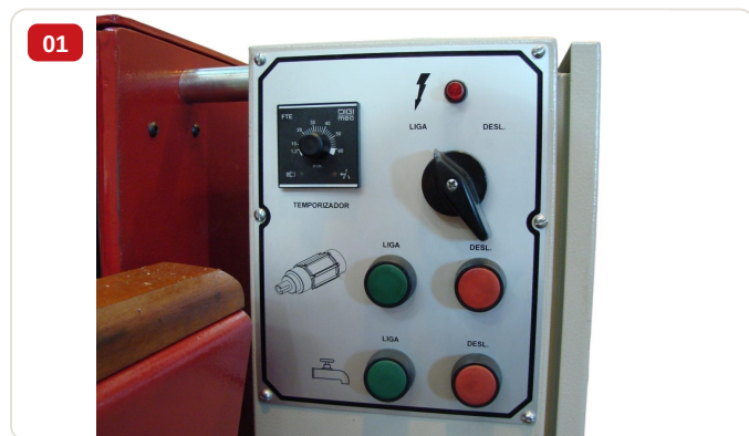
Detalle — Panel de control de la bruñidora BB-98 con temporizador y botones encendido/apagado
