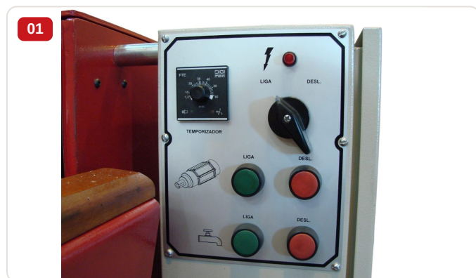
Detalhe — Painel de controle da brunidora BB-98 com temporizador e botões liga/desl. para operação
