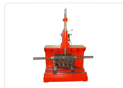
Mandrinadora de cilindros BCP-1000 Chinelatto con bloque de motor en hierro fundido en la mesa
