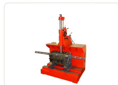
Mandrinadora de cilindros BCP-1000 Chinelatto con bloque V8 de hierro fundido posicionado para mandrinado
