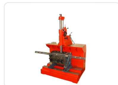
Broqueadora de cilindros BCP-1000 Chinelatto com bloco V8 em ferro fundido posicionado para mandrilamento
