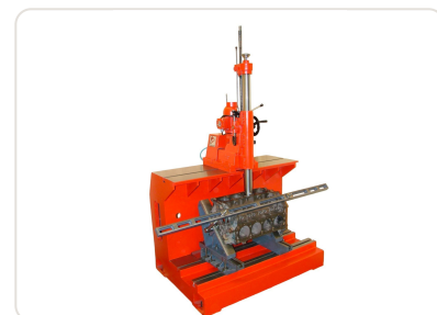
Broqueadora de cilindros BCP-1000 Chinelatto com bloco de motor para mandrilamento pneumático
