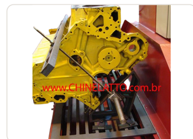
Bloque de motor V8 en hierro fundido posicionado en la mandrinadora BH-200 para mandrinado de cilindros
