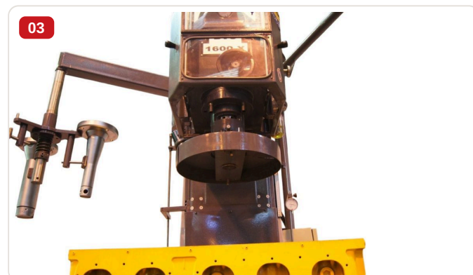
Detalle — Cabezal de mandrinado de la BVC-1600X con eje portaherramientas y reloj comparador para centrar piezas
