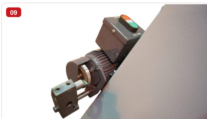
09 Accesorio normal — Motor eléctrico con panel de control start/stop de la mandrinadora BVC-1600X Chinelatto
