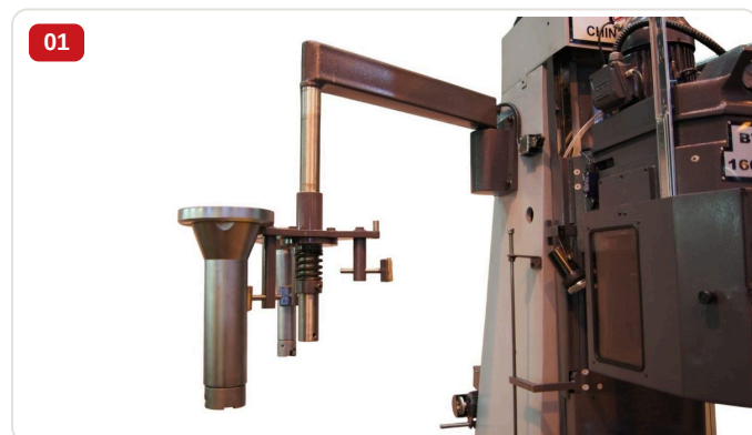
Accesorio normal — Cabezal de mandrinado de la máquina BVC-1600X con eje portaherramientas y herramienta instalada
