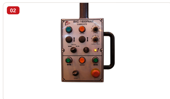
Detalle — Panel de control BVC-1600PAAX con botones encendido/apagado y perillas graduadas para mandrinadora
