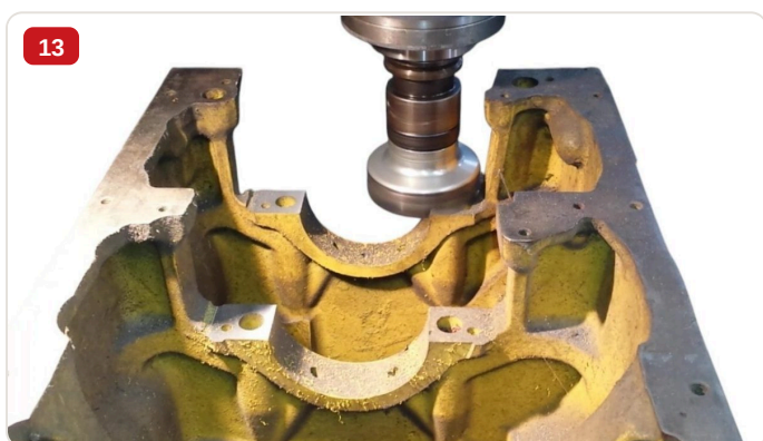
Detalle — Bloque de motor en hierro fundido siendo cepillado en la brocadora BVC-1600X con sistema de fijación
