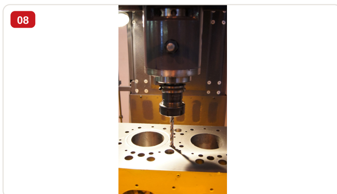
08 Detalhe — Broca helicoidal usinando peça de alumínio com furos circulares na broqueadora BVC-1600X
