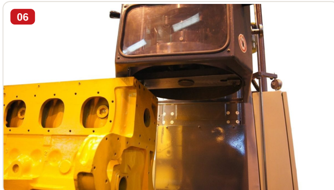
06 Detalhe — Bloco de motor em ferro fundido posicionado para plainamento na broqueadora BVC-1600X
