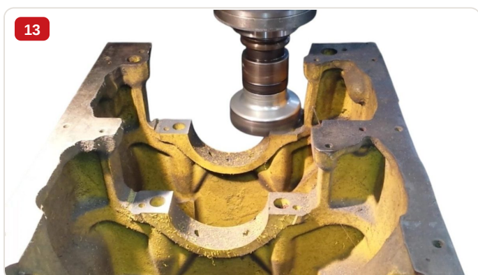
Detalhe — Bloco de motor em ferro fundido sendo plainado na broqueadora BVC-1600X com sistema de fixação
