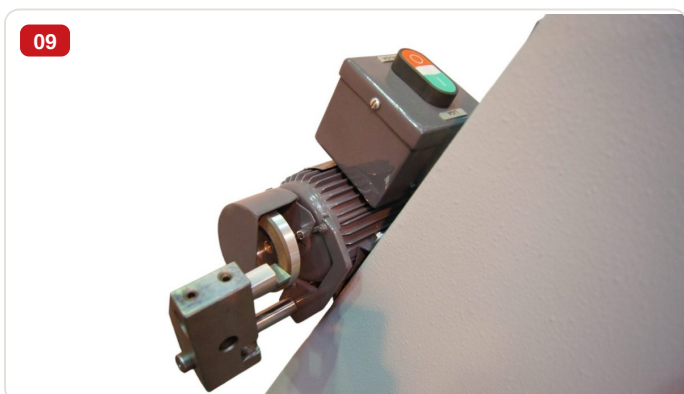
09 Acessório normal — Motor elétrico com painel de controle start/stop da broqueadora BVC-1600X Chinelatto
