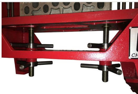
Detalle — Manivelas de ajuste de la altura de la culata con roscas de precisión en la mandrinadora EMC-2
