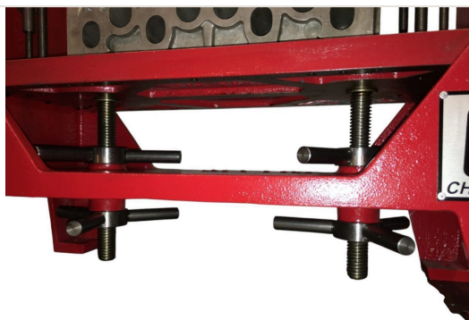
Detalhe — Manivelas de ajuste da altura do cabeçote com roscas de precisão na mandrilhadora EMC-2
