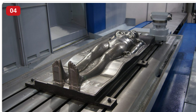
Detalle — Molde de aluminio mecanizado con cavidades para figura humana en la mesa de la fresadora portal CNC FP-3000
