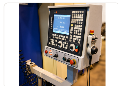
Accesorio normal — Panel de control CNC FAGOR con pantalla de coordenadas y teclado para fresadora portal FP-3000
