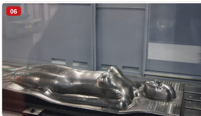
Detalle — Pieza metálica en hierro fundido siendo mecanizada en fresadora portal CNC FP-3000
