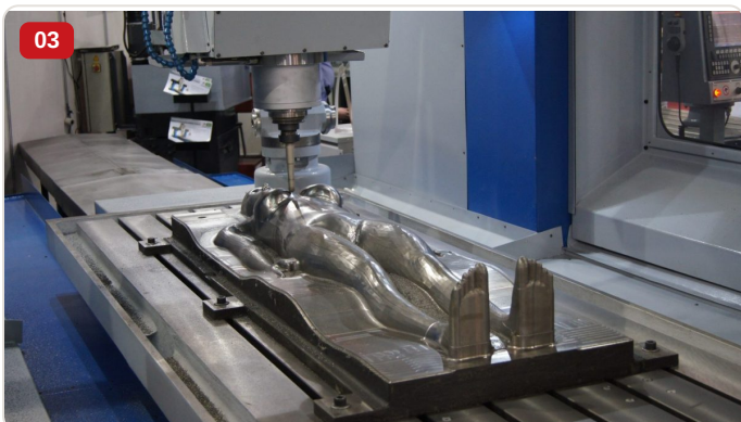
Detalle — Fresadora portal CNC FP-3000 mecanizando molde en hierro fundido con figura humana en relieve
