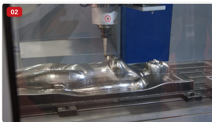
Detalhe — Peça metálica sendo usinada na fresadora portal CNC FP-3000 com refrigeração ativa
