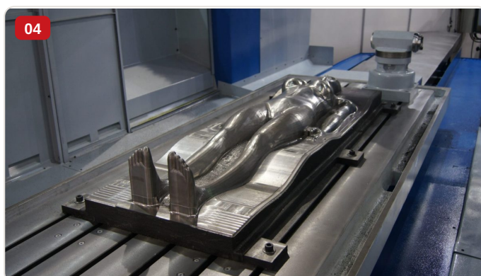
Detalhe — Molde de alumínio usinado com cavidades para figura humana na mesa da fresadora portal CNC FP-3000
