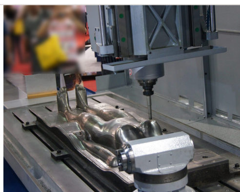
Detalhe — Usinagem sendo feita pela Fresadora portal CNC FP-3000
