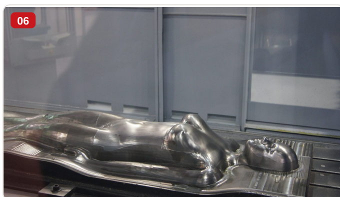
Detalhe — Peça metálica em ferro fundido sendo usinada na fresadora portal CNC FP-3000
