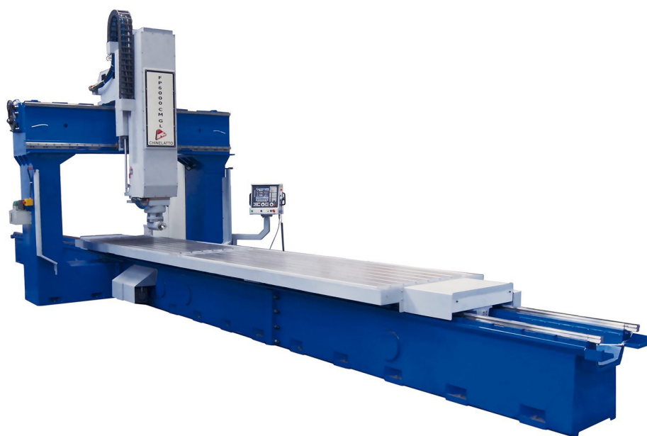
Fresadora Portal CNC FP-6000CM x 2200 mm - com carenagem
