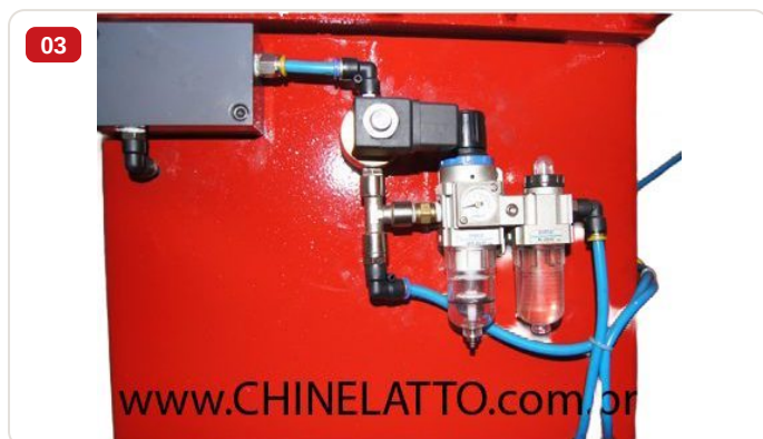
Detalle — Sistema neumático con filtro regulador para aire comprimido de fresadora FRECAB - vista 1/2
