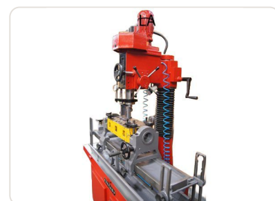
Fresadora de sede de válvula FRECAB Chinelatto — vista geral da máquina com mesa inclinável
