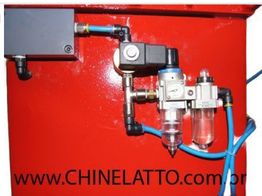
Detalhe — Sistema pneumático com filtro regulador para ar comprimido da fresadora FRECAB - vista 1/2
