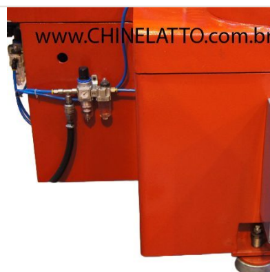
Detalhe — Sistema pneumático com válvulas e reguladores para automatização da fresadora FRECAB
