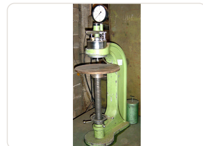
Durômetro de bancada: - Utilizado para medição da dureza do material (HB)
