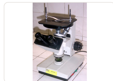
Microscópio Óptico: - Utilizado para análise metalográfica do material
