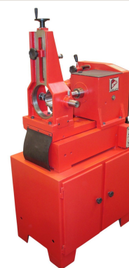
Detalhe — Mandrilhadora de bielas MB-125 Chinelatto para mandrilamento Ø15-125mm, motor 1,0cv
