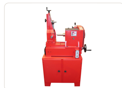
Mandrilhadora de bielas MB-125 Chinelatto capacidade Ø15-125mm para mandrilamento de bielas
