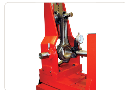
Biela de ferro fundido posicionada na mandrilhadora MB-125 com relógio comparador para medição
