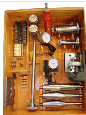
Acessório normal — Kit de acessórios para mandrilhadora de bielas MB-125 com ferramentas, relógios comparadores e dispositivos
