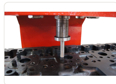
Retirando - instalando guias
