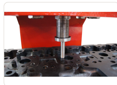
Retirando - instalando guías
