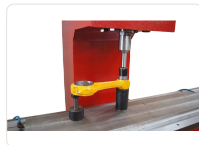
Instalando bucha da biela
