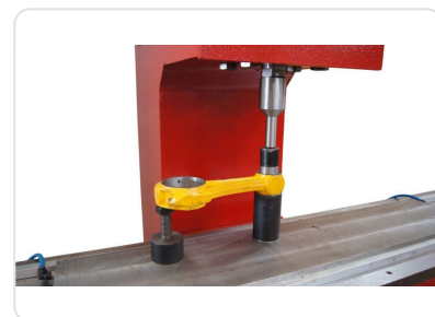
Instalando bucha da biela
