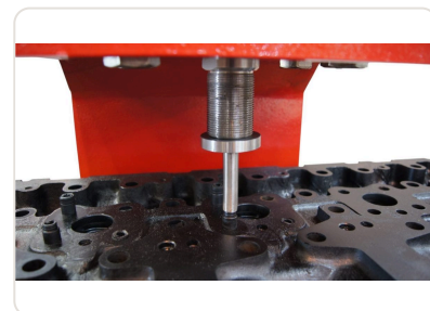
Retirando - instalando guias
