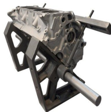
Accesorio opcional — Dispositivo DB-30/45 para bloques en "V" de hierro fundido para fijación
