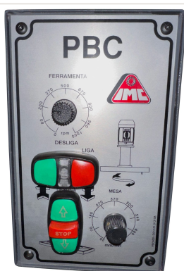
Detalle — Panel de control con controles rotativos para RPM y velocidad de mesa de cepilladora PBC-1200X
