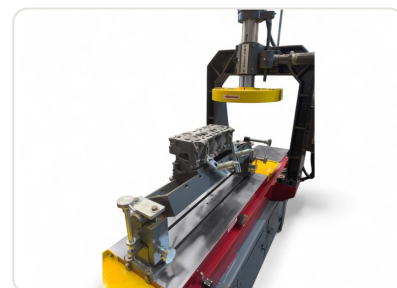
Cepilladora PBC-1200X cepillando culata en aluminio con dispositivo de inclinación
