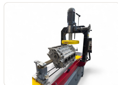
Cepilladora PBC-1200X cepillando culata de motor V8 en aluminio — vista 1
