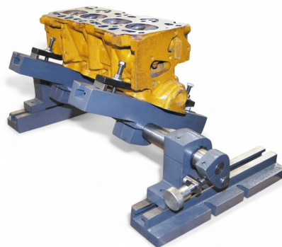
Acessório opcional — Dispositivo DI para cabeçotes com inclinação, estrutura articulada para fixação na plaina PBC-1200X
