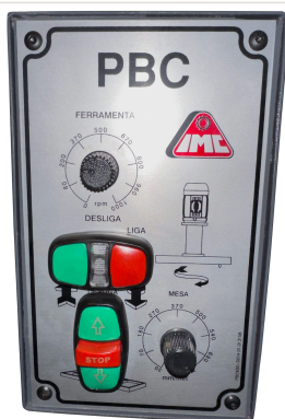
Detalhe — Painel de Comando com controles rotativos para RPM e velocidade da mesa da plaina PBC-1200X
