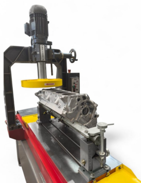
Detalhe — Plaina PBC-1200X plainando cabeçote de motor V8 em alumínio — vista 2
