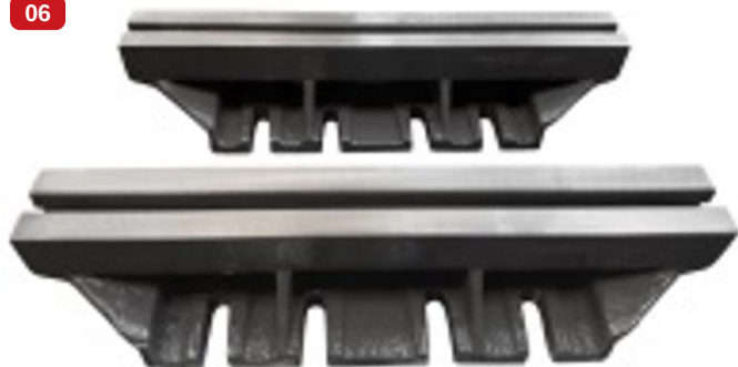
Acessório normal — 01 Par Calço - altura 100 mm de ferro fundido para fixação na plaina PBC-1200X
