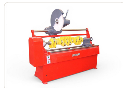
Pulidora de cigüeñal PV-1500 Chinelatto con motor 3CV y capacidad Ø400x1500mm para rectificado
