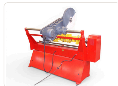
Polidora de virabrequim PV-1500 Chinelatto Ø400x1500mm com motor 3CV e disco polidor Ø500mm
