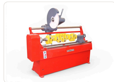
Polidora de virabrequim PV-1500 Chinelatto com motor 3CV e capacidade Ø400x1500mm para retífica
