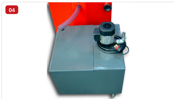
Accesorio normal — Reservorio de refrigeración con electrobomba 0,12 cv y sistema de circulación para rectificadora RMG-460X
