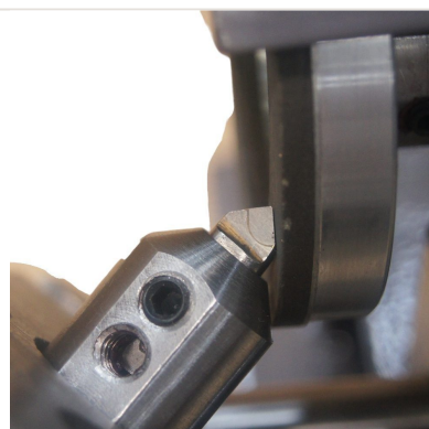
Detalle — Afilado - Ángulo de salida - Alineadora de bancadas - Rectificadora portatil de cilindros
