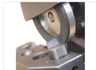
Afilado - Ángulo de ataque - Cuchilla Rectificadora de cilindros de columna
