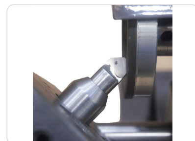
Afilado - Ángulo de salida - Cuchilla Cepilladora
