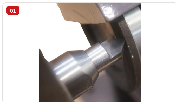
Detalle — Afilado - acabado - Cuchilla Cepilladora
