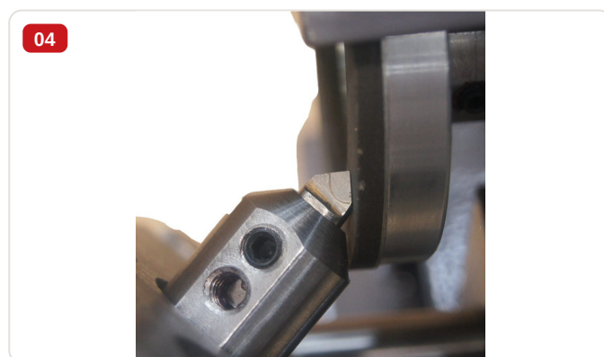
Detalle — Afilado - Ángulo de salida - Alineadora de bancadas - Rectificadora portatil de cilindros
