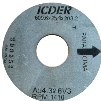
Accesorio opcional — Piedra - Ø610mm (24'') - espesor: 17 - 19 - 25 - 32 - 38 mm
