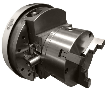
Accesorio normal — Platos de centrado en cruz con 3 garras hidráulicas en hierro fundido para fijación de cigüeñal
