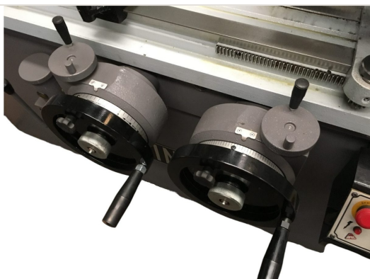
Detalhe — Volantes de movimentação manual em ferro fundido com alças para controle de avanços da retífica RVC-1000M
