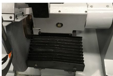
Detalhe — Proteção do barramento porta-rebolo com fole sanfonado em metal para retífica RVC-1000M
