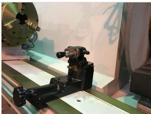
Accesorio normal — Dressador para reacondicionamiento de la muela en rectificadora de cigüeñal RVC-1500M
