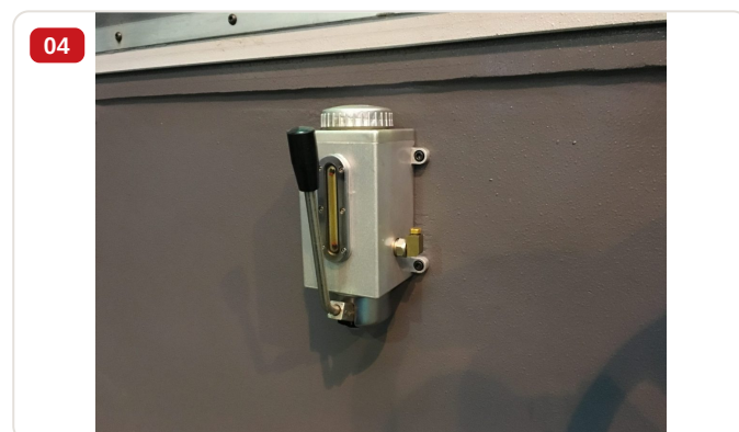
Accesorio normal — Bomba de lubricación manual del bancada con depósito y visor de nivel
