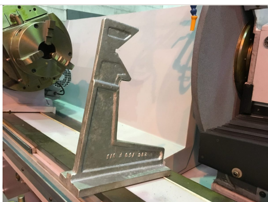
Accesorio normal — Dispositivo en V para centralizar biela en hierro fundido sobre mesa de rectificadora
