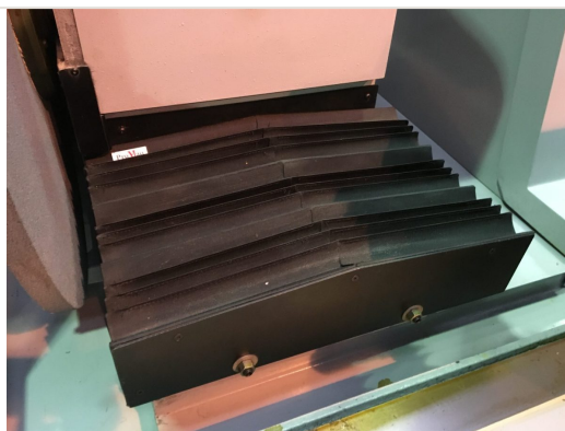
Acessório normal — Proteção sanfonada sobre o barramento da retífica de virabrequim RVC-1500M
