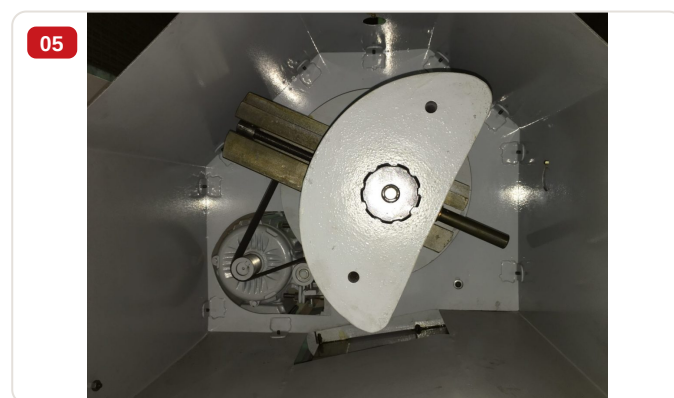
Detalhe — Sistema de avanço e contra-peso do cabeçote porta-rebolo com volante micrométrico manual
