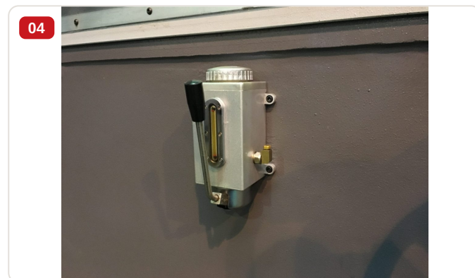
Acessório normal — Bomba de lubrificação manual do barramento com reservatório e visor de nível
