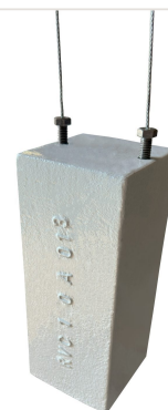
Detalhe — Contra peso do carro do rebolo
