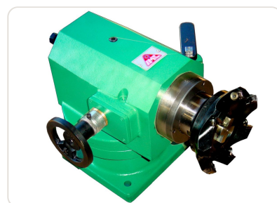
Subcabeçote fresador angular 90° CF-1 em ferro fundido com cone ISO 40 e giro manual 360°
