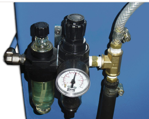
Detalhe — Sistema pneumático com regulador Parker, manômetro e filtro para ar comprimido 6 bar da fresadora SUPREMA-P
