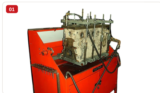
Detalle — Probadora de presión TESTRIM con culata montada para detección de grietas y fugas
