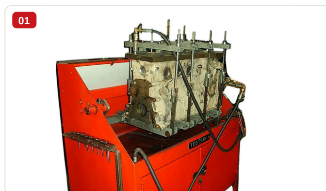
Detalhe — Testadora de pressão TESTRIM com cabeçote montado para detecção de trincas e vazamentos
